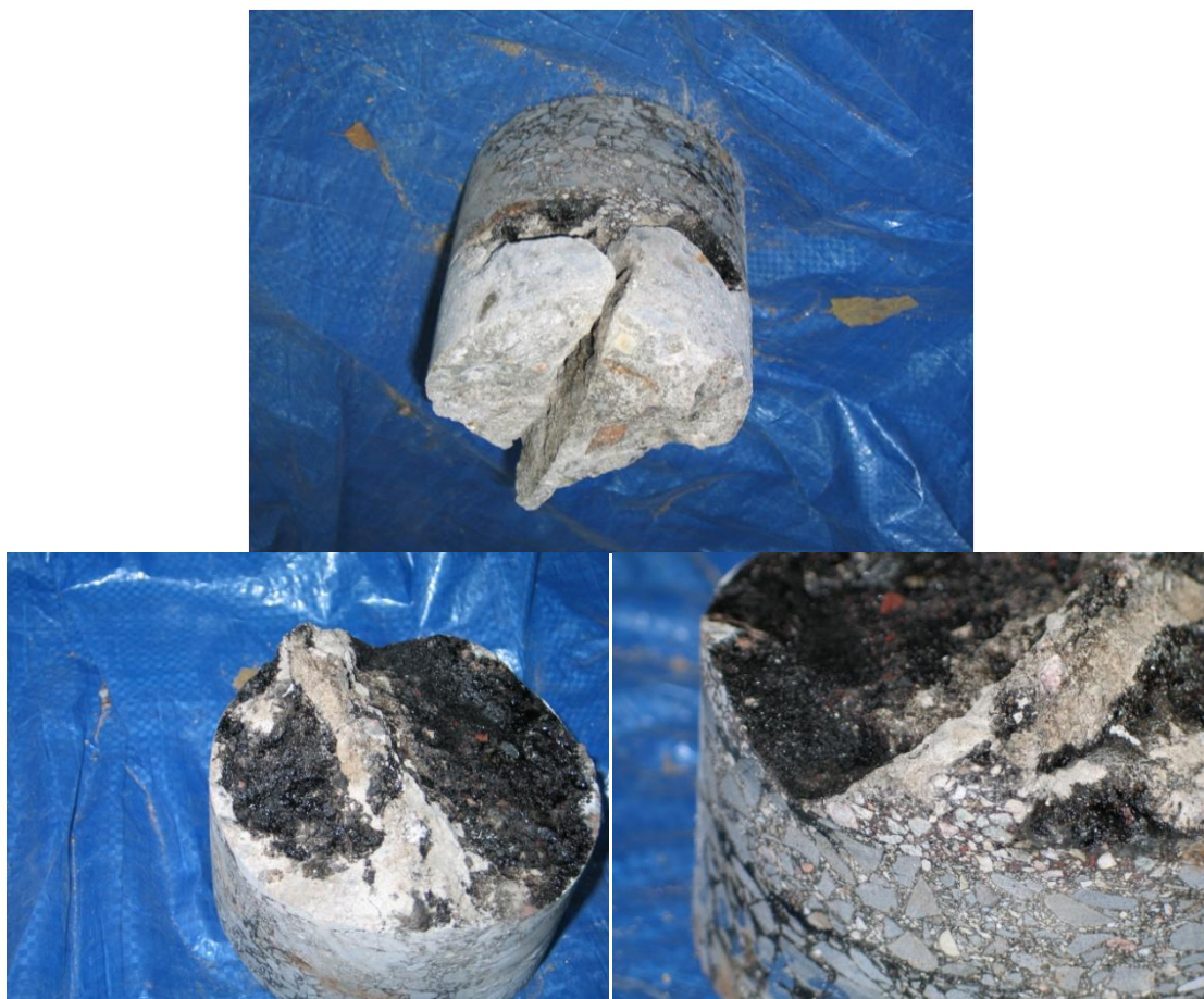
Rysunek 2.11 Uzyskane fragmenty rdzenia W2_A1_S poskładane do konfiguracji pierwotnej oraz spąg warstw asfaltowych widziany od dołu z widocznym asfaltowym odlewem szczytu szczeliny jaka wcześniej powstała w betonie. Szczyt szczeliny wypełnia mieszanka o najdrobniejszym kruszywie (zbliżenia) użyta zapewne przy wcześniejszej naprawie nawierzchni betonowej.
